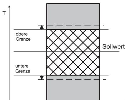
Bild 8: Bandalarm, Alarmkontakt invers
